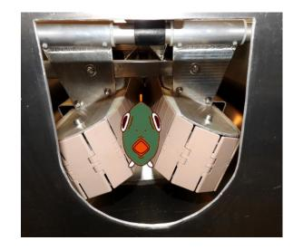
2 schräg stehende Bandsysteme bilden ein V in dem die Fische befördert werden. Der Abstand der Bänder zueinander kann hinten und vorne eingestellt werden. So entsteht ein sich weitender Spalt. Je nach Größe fallen die Fische früher oder später in die darunter befindliche Wanne und werden mit Wasser aus der Maschine gespült. Die Bandgeschwindigkeit ist stufenlos einstellbar.
